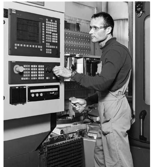
Bild 5: An diesem den Vorschriften entsprechenden Bearbeitungszentrum darf nur im Normalbetrieb allein gearbeitet werden. Für die Behebung von Störungen, für den Werkzeugwechsel und für Instandhaltungsarbeiten muss eine Sicht- und Rufverbindung zu einer zweiten Person bestehen.
